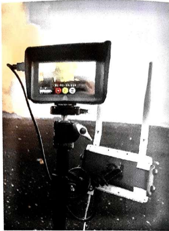
Рис. 93. Станция усиления сигнала на штативе с дополнительным средством отображения информации (вариант)
