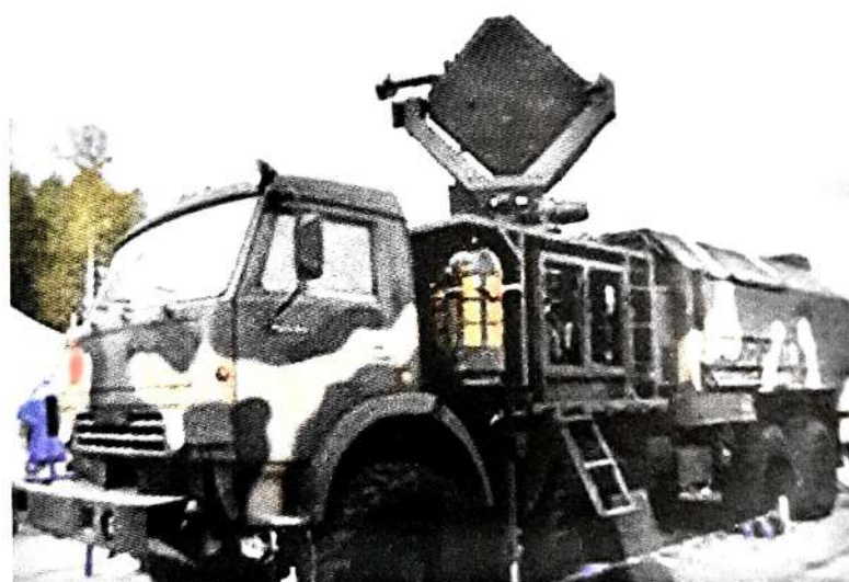
Рис. 23. Межвидовой радиопеленгационный метеорологический комплекс «Улыбка-М»
