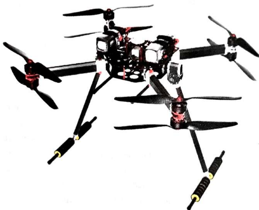
Рис. 89. Квадрокоптер с совмещенными винтами (вариант)
