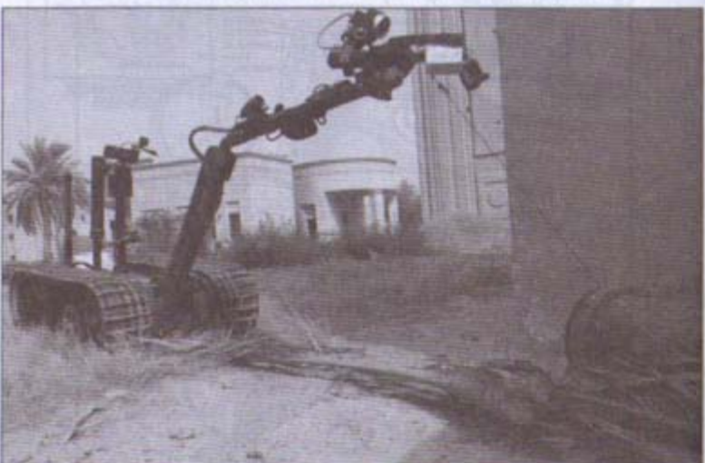
Дистанционно управляемая машина разминирования, применявшаяся американскими войсками в Ираке. Фото с сайта www.militaryphotos.net
