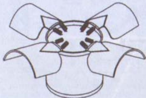
Схема югославской касетной противотанковой противоднищевой мины КПОМ-2 («ORDATA-2»)
