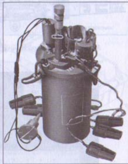
Советское неконтактное взрывательное устройство НВУ-П. Фото из архива А.В. Мусиенко
