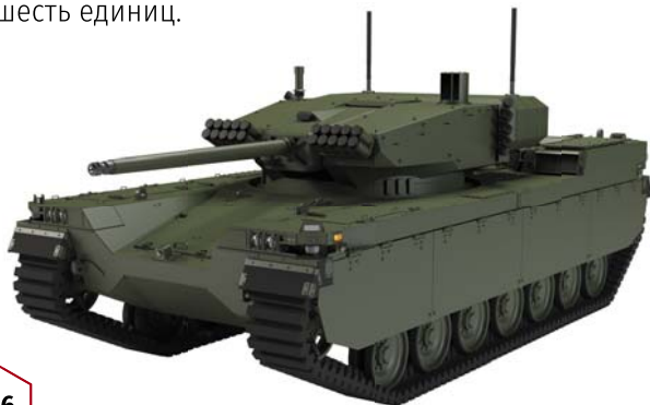
Беспилотный легкий танк Milrem Robotics Type-X с расширенной башней и 30-мм пушкой
