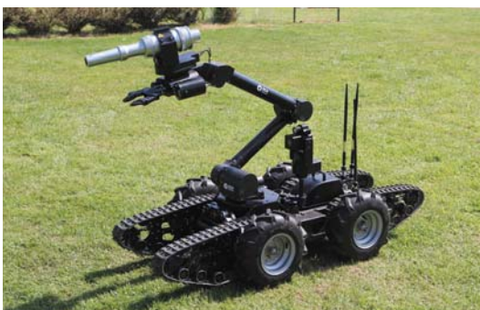
Комплекс Iguana оснащен гидропушкой высокого давления
