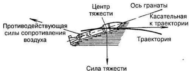
Рис. 15. Действие силы сопротивления воздуха на полет гранаты
