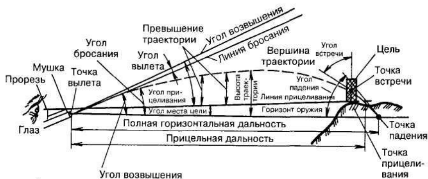
Рис. 14. Траектория пули (вид сбоку)
