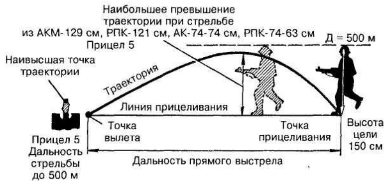
Рис. 16. Прямой выстрел по бегущей фигуре при стрельбе из автомата АКМ и ручного пулемета РПК
