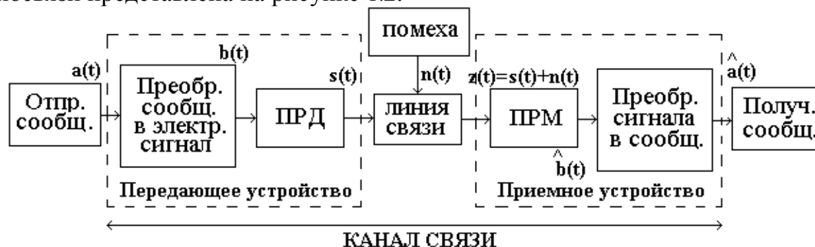
Рисунок 1.2 – Обобщенная структурная схема простейшей одноканальной системы радиосвязи
