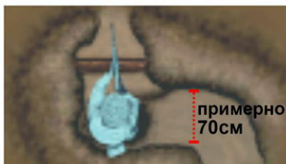
Размеры стрелковой ячейки при срочном окапывании
