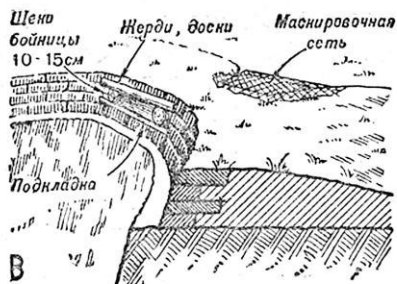
Рис. Устройство покрытых бойниц:
