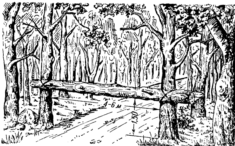
Рис. 134. Противотанковый барьер из бревен.
